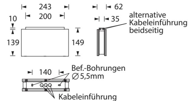
Gehäuseausführung / Casing design / Configuration logement
