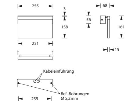
**Gehäuseausführung / Casing design / Configuration logement**
