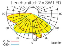
Lampenlichtstrom Not / Netz: 480lm / 360lm – Nennbetriebsdauer: 1h/3h
