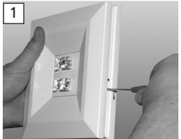
Öffnen Sie die Leuchte durch das Einstecken eines Schraubendrehers (max. Ø 2,5mm) in die mit dem Pfeil gekennzeichneten Löcher zwischen den Gehäuseschalen und drücken beide Schalen auseinander.
