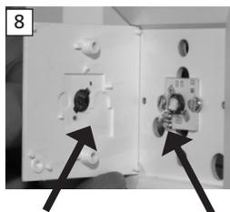
Beim Aufsetzen der Optik-Halteplatte achten Sie darauf, dass die Kabelausnehmung über den Kabeln der LED positioniert ist.
