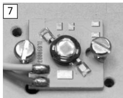
Fädeln Sie das LED-Modul mit dem Langloch zuerst wieder ein. Drücken Sie das Halbloch an die andere Schraube und ziehen die Schrauben wieder fest an.
