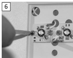
Lösen Sie die beiden LED-Modul-Befestigungsschrauben so weit, dass das LED-Modul ausgefädelt werden kann.
